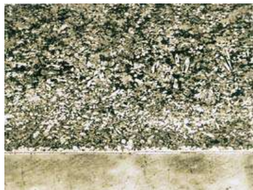
▲ 皮膜のマイクロ組織 Ni-Crのマトリックス中にCrB、CrCが析出している。
