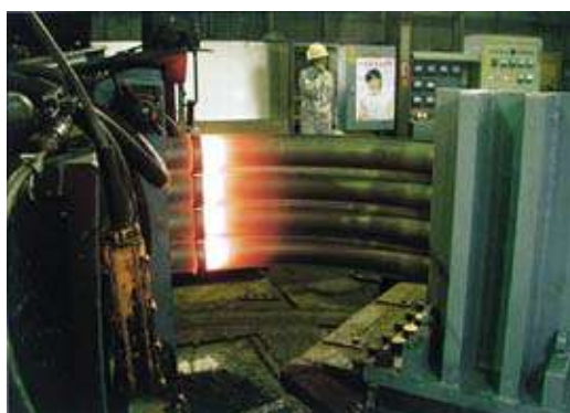
▲ 水壁パネル溶射品の高周波曲げ加工写真
