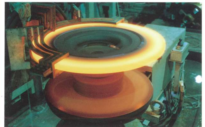
リングの回転一発焼入れ Rotary single shot hardening of rings
