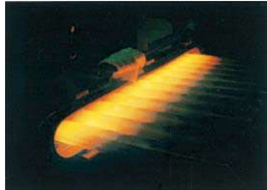
▲ 直管パネルの高周波フュージング
