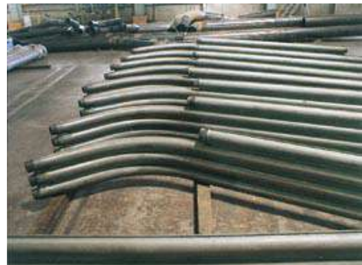
▲ 高周波曲げ処理された溶射パネル
