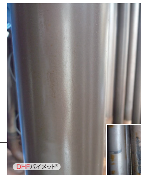
バイオマスボイラ層内伝熱管 (1年間使用後)
