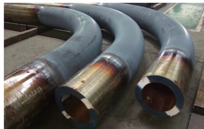
厚肉ベンド 発電プラント等に採用されており、Max.130mmWTまで曲げられます。
