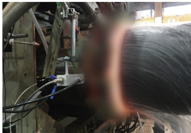
連続測温システム搭載高周波曲げマシン
