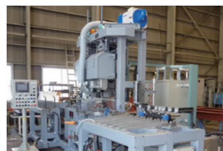
鋼管焼入れ装置(ドアイパクトビーム)
