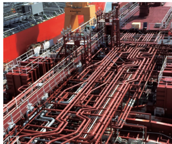
造船配管 船舶の限られた船内配管で、作業効率が良い高周波曲げ加工管を提供しています。既製品であるエルボと同等の曲げ半径にて加工が可能であり、日本海事協会の認証も取得しています。VLCC船、FPSO船、LNG船、コンテナ船などに採用されています。
