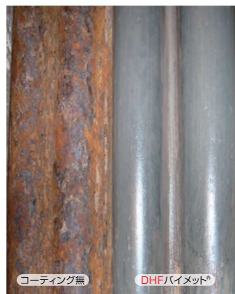
清掃工場ボイラ水冷壁 (3年間使用後)
