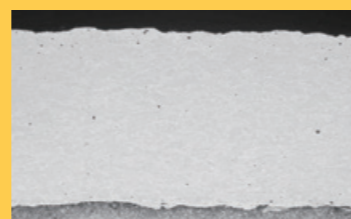
DHFバイメット® 皮膜マイクロ写真
