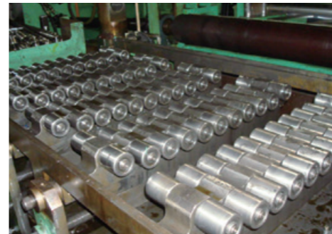
レベラー設備バックアップロール
