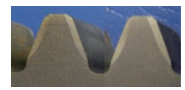
レーザー焼入の断面 マクロ
