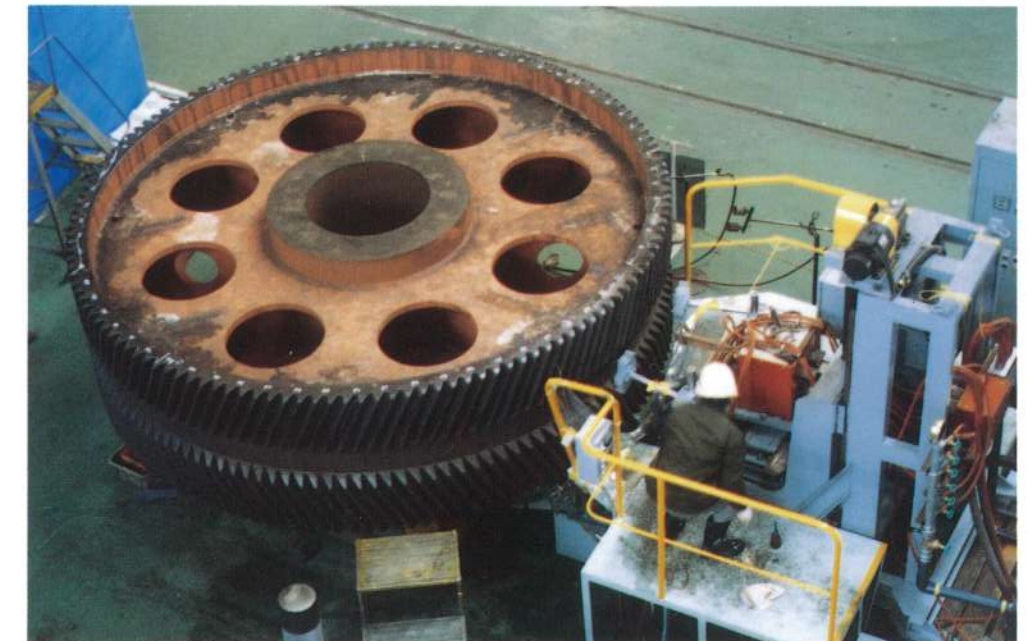
大型歯車現地焼入れ On-Site Gear Hardening
