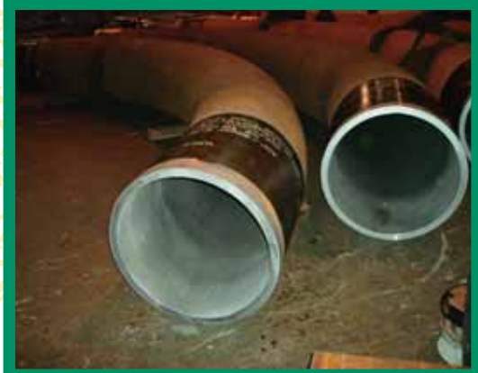
母材(外): API 5LX65 / 合せ材(内): ALLOY625
